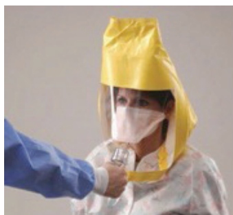
Figura 7. Prueba de ajuste cualitativa
